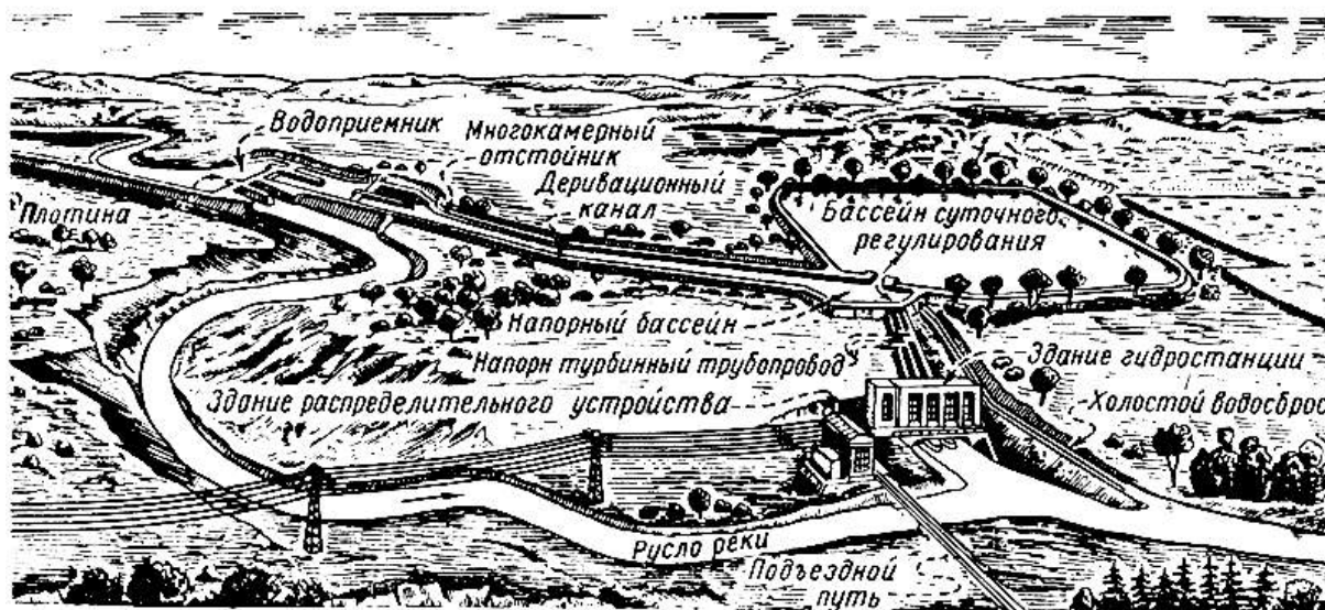
Рисунок 1 – Схема ГЭС с деривацией в виде открытого канала
