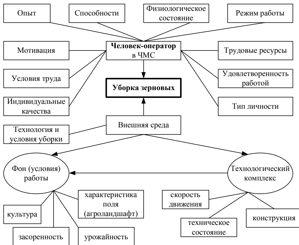
Рисунок 1 – Блок-схема, учитывающая влияние характеристик человека-оператора на процесс уборки зерновых
