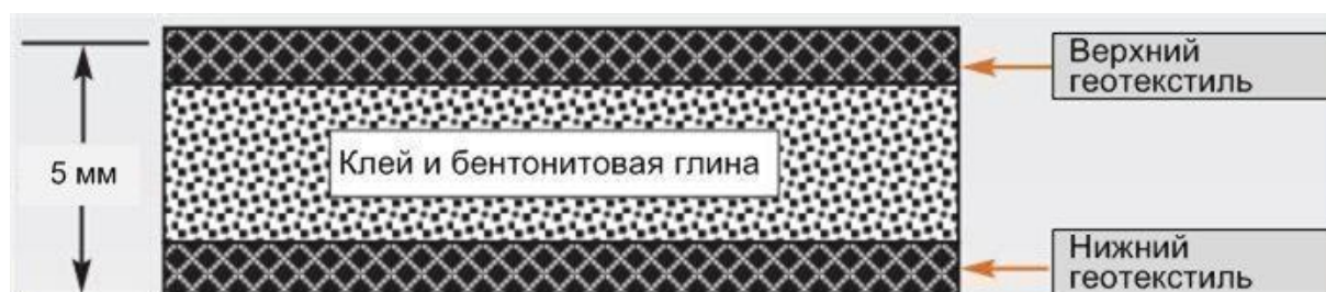
Рисунок 5 –Склеенный тип скрепления геотекстильных покрытий
