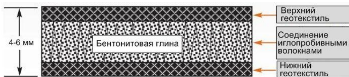
Рисунок 4 – Иглопробивной тип скрепления геотекстильных покрытий
