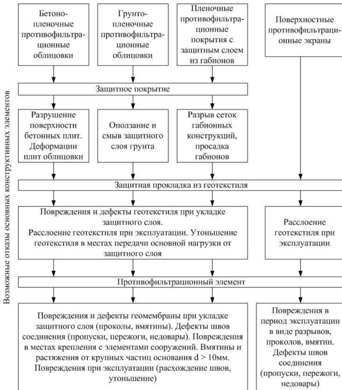
Рисунок 3 – Виды отказов конструктивных элементов противofiltrационных облицовок
