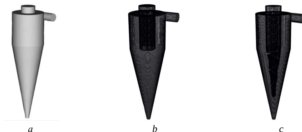
Рисунок 2 – Твердотельная (a) и расчетные модели гидроциклона-осветлителя без насадки (b) и с насадкой (c) Figure 2 – Solid-state (a) and calculation models of a clarifying hydrocyclone without nozzle (b) and with nozzle (c)
