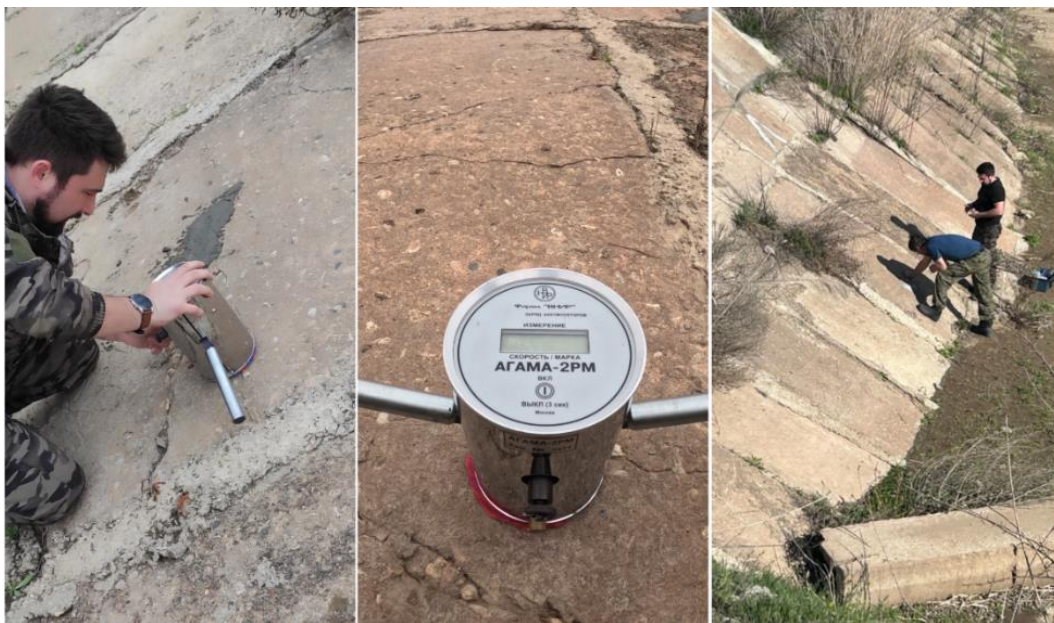
Рисунок 2 – Определение водонепроницаемости прибором «АГАМА-2РМ» (фото И. А. Коваленко) Figure 2 – Determination of water impermeability with a device AGAMA-2RM (photo by I. A. Kovalenko)
