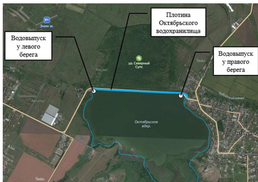
Рисунок 1 – Состав сооружений Октябрьского водохранилища (автор фото А. С. Романова)
