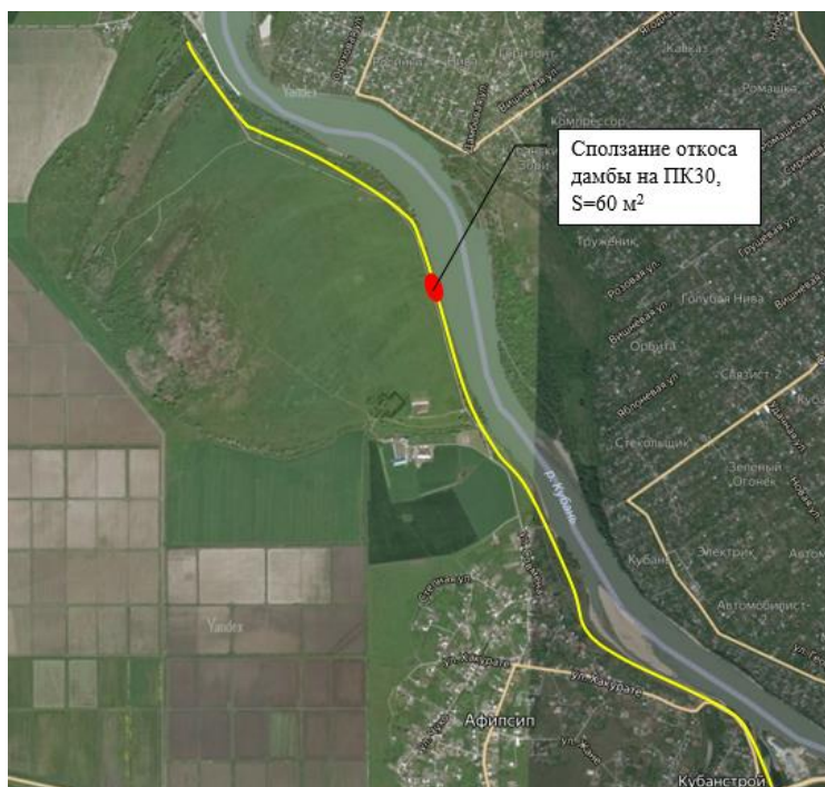
Рисунок 6 – Возможное сползание откоса на ПК30 инженерной защиты левого берега р. Кубань Figure 6 – Possible slope slippage on PK30 engineering protection of the left bank of the Kuban River
