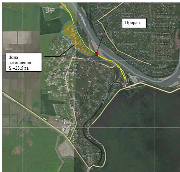
Рисунок 5 – Возможное образование прорана на ПК10 инженерной защиты левого берега р. Кубань Figure 5 – Possible formation of outlet on PK10 engineering protection of the left bank of the Kuban River
