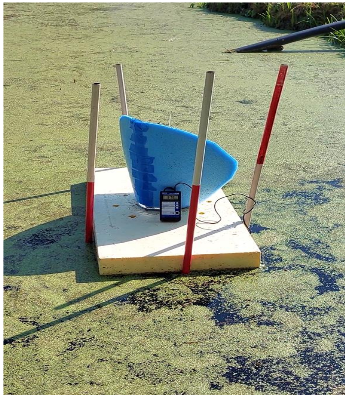
Рисунок 2 – Экспериментальная установка для оценки содержания РК в условиях резервного пруда (автор фото Хуссейн Исмаил)
