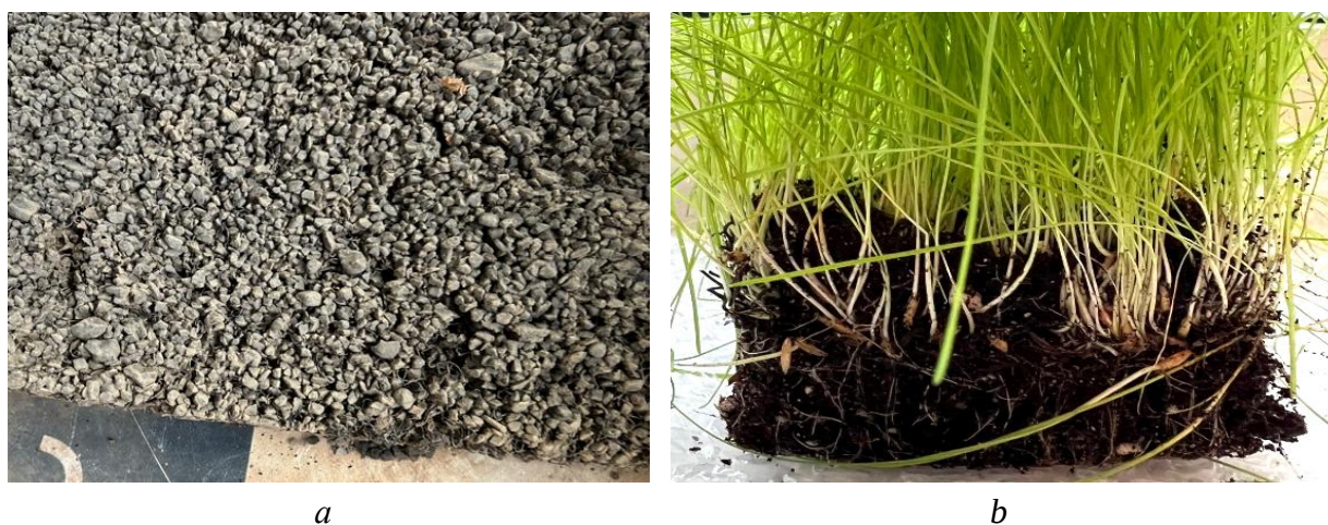
a – Энкамат А20 с заполненным битум-полимерным вяжущим и щебнем; b – Энкамат 7225 с растительностью
