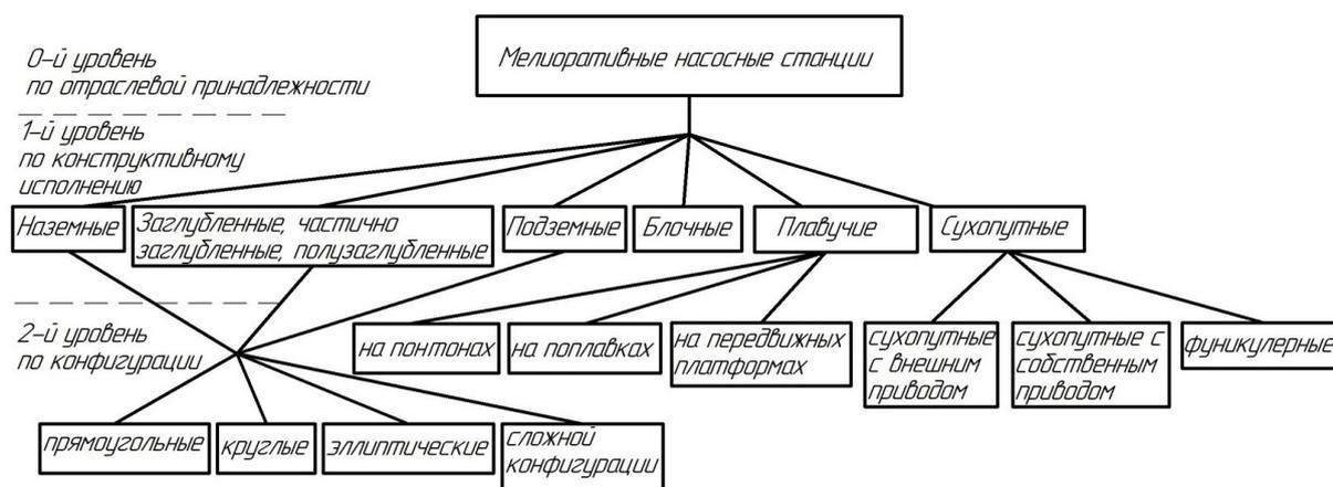
**Рисунок 2 – Иерархическая классификация мелиоративных насосных станций различного назначения по конструктивному исполнению и конфигурации**
