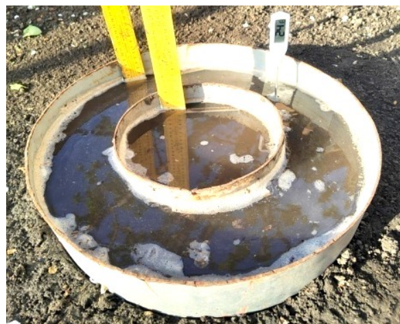
Рисунок 3 – Процесс определения коэффициента фильтрации на участке Яшкульского распределительного канала (автор фото Д. В. Бакланова)
