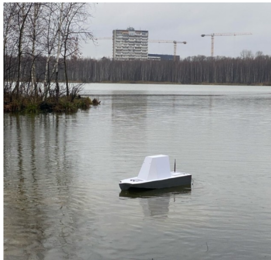
Рисунок 2 – Беспилотный катер в ходе проведения эхолотной съемки (фото из личного архива Н. О. Науменко)
