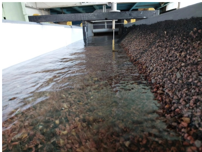
Рисунок 3 – Общий вид фрагмента экспериментальной установки канала, покрытого Энкаматом 7225, заполненным щебнем с размером фракций от 6 до 10 мм (автор фото Т. Ю. Жукова) Figure 3 – General view of a fragment of the experimental facility of a channel covered with Enkamat 7225, filled with crushed stone with a fraction size of 6 to 10 mm (photo by T. Yu. Zhukova)
