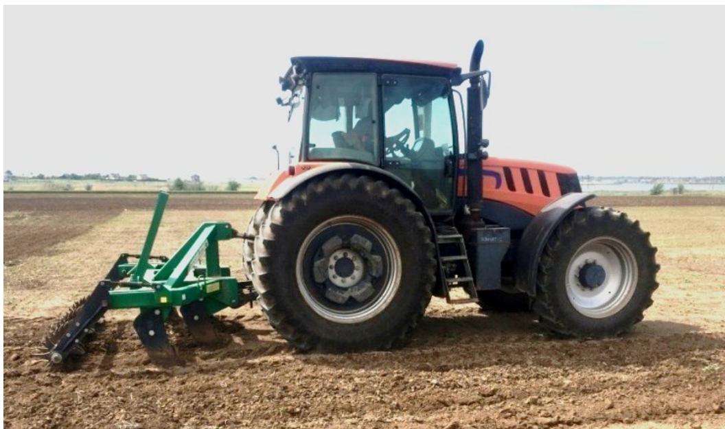
Рисунок 1 – Глубокое рыхление почвы плугом чизельным ПЧ-2,3Н (автор фото К. А. Родин)
