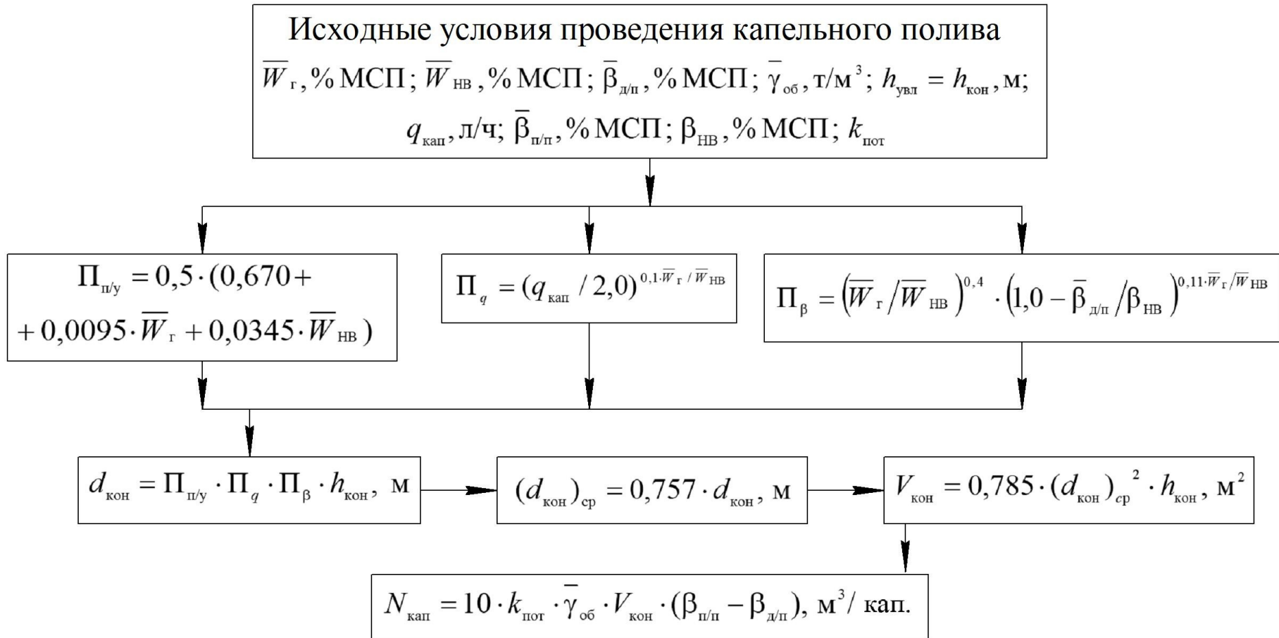
Рисунок 2 – Блок-схема алгоритма определения нормы водоподачи на один капельный микроводовыпуск Figure 2 – Algorithm flow chart for determining the water supply rate to one drip micro-water outlet
