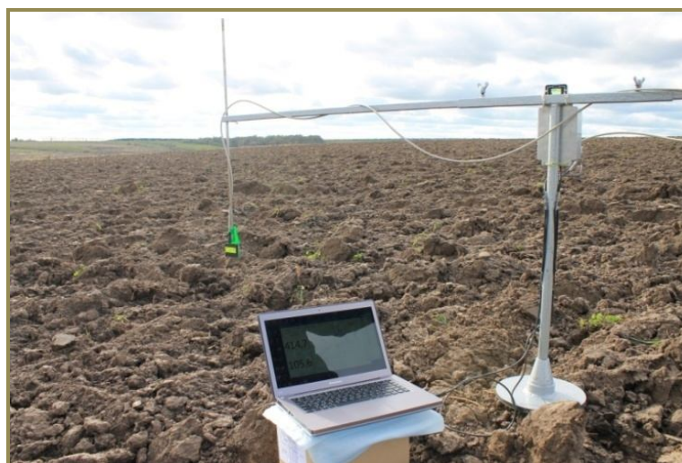
Рисунок 6 – Общий вид изготовленного бесконтактного профилографа (автор фото С. А. Васильев)
