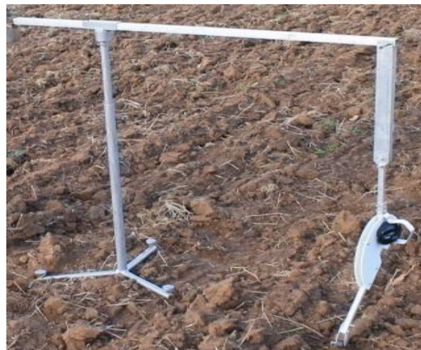
Рисунок 1 – Принципиальная схема контактного профилографа (патент РФ № 2560752)
