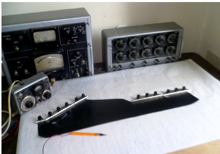
Рисунок 3 – Электрическая модель канала в насыпи, выполненная на электропроводной бумаге (автор фото Д. В. Бакланова)
